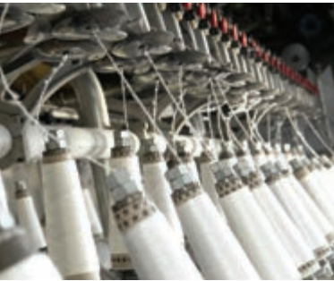
Abb. 8 – Herstellung von Garn durch Verdrillen
